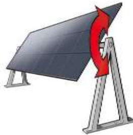
Gambar 1. Tracking Matahari satu Sumbu.
