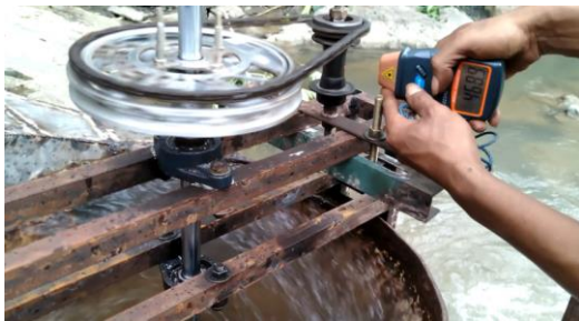
Gambar 5 Pengujian RPM Gear 46 : 16
