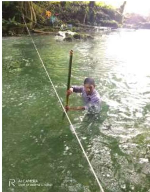
Gambar 3. Pengukuran Lebar dan Kedalaman Sungai
