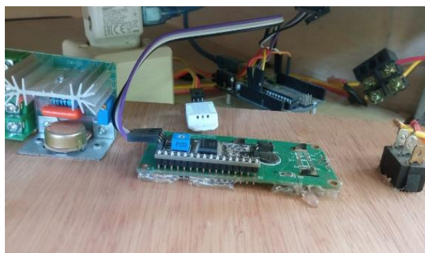
Gambar 4. Rancangan Komponen Pengering Bawang Otomatis dengan Mikrokontroler
