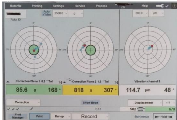
Gambar 1. Hasil pre-balancing berupa plot polar ketidakseimbangan awal.
