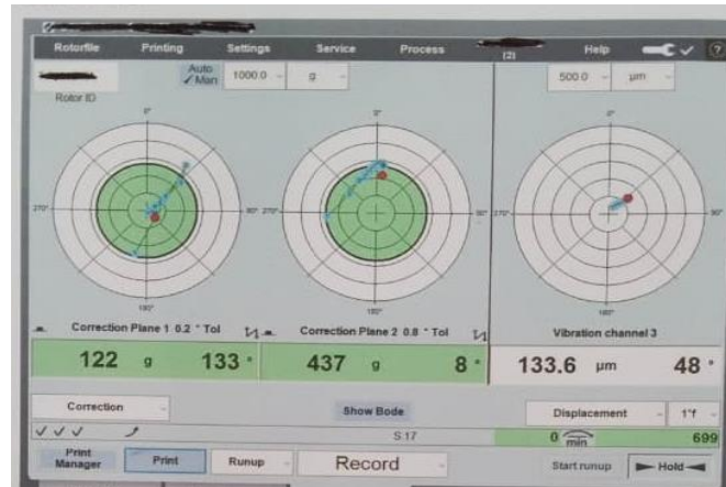
Gambar 3. Hasil balancing akhir dalam zona toleransi (zona hijau)
